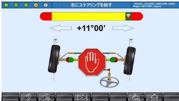
赤いボールマークが右の緑色の範囲に到達するまで、ステアリングを右に回転させます。緑色の範囲に到達し、
