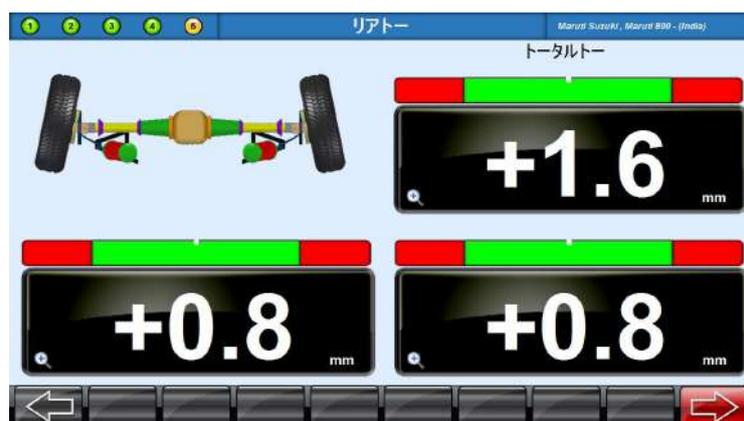
極力左右が均等になるように調整し、ロックナットを締めます。
