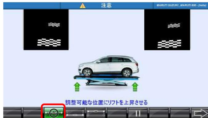
リフトを作業高さまで上下させ、
