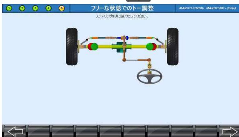
調整可能な位置に達するまでホイールを左に回転させ、画面の指示に従ってステアリングをロックします。
