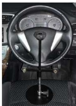
ステアリングロックは、トー調整時にステアリングの動きを固定するために使用するストッパーです。
