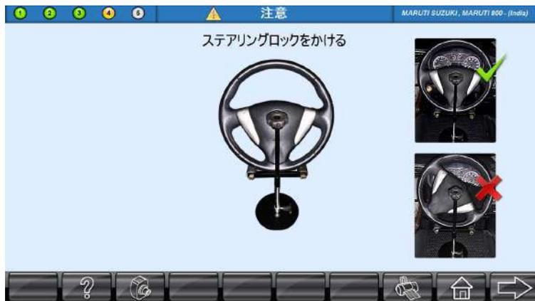
ステアリングのセンターが確定したら、ステアリングロックでステアリングが回転しないように固定します。
