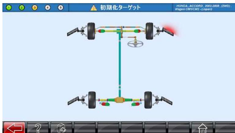
ランアウト中に、カメラとターゲットプレート間に障害物があると次の画面が表示されます。『×』は未検出のターゲットプレートです。障害物がある場合は取り除いてください。
