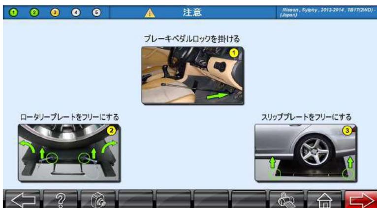
ブレーキペダルロックを使用してブレーキをかけ、ロータリープレートとスリッププレートのロックピンを取り外してから、ターゲットの水準器を使用してターゲットプレートが水平であることを確認してください。
