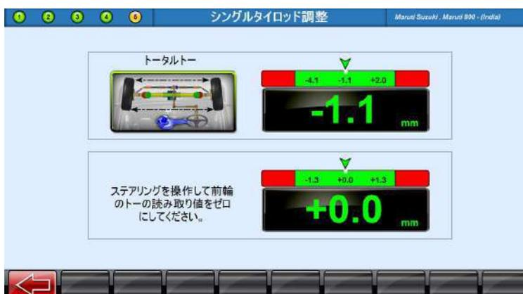
アジャスターを回し、表示されているトータルトーを基準値に調整します。
