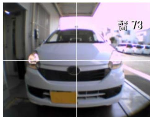
**⚠ 注意** 車両正対を行う際、車両正対ツマミを1.2mm(約4/5回転)移動させた場合、10m前方では50mmのズレを生じることになります。
