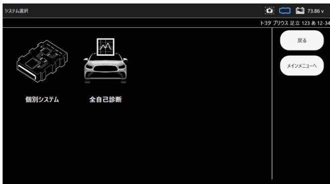
(2) 各システムの故障コードの確認が開始されます。
