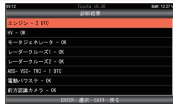
故障コードと内容を確認するには確認するシステムを選択して「ENTER」ボタンを押します。続いて「故障コードの読取り」を選択して「ENTER」ボタンを押します。
