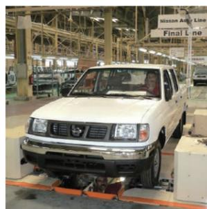
車両の走行系統の各種検査・調整のためのホイールアライメント、サイドスリップテスター、フリーローラーテスター、ブレーキテスター、ヘッドライトテスターなどのテスター装置です。長年の経験とお客さまとの共同開発で培ったノウハウを元に、安全・安心・高性能な商品を提供しています。
