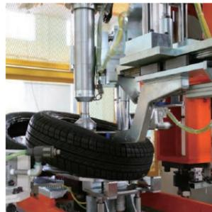
タイヤとホイールを自動組付けする装置で、高剛性タイヤからテンポラリータイヤまでワイドレンジ対応が可能、軽自動車から大型トラック用まで対応可能です。また、設備前後の搬送装置及びバランス測定工程までシステム提供いたします。高速で処理し安全性にも実績を積んだ高性能な設備で省力化・省人化に貢献します。
