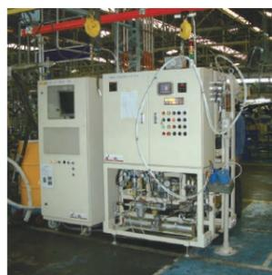
車両ブレーキ、クラッチシステム、冷却システムなどにブレーキ液や冷却液を真空充填すると同時にシステム内の気密試験を行い、各システムの品質向上に貢献、省人効果が図れ、コスト抑制に役立ちます。汎用ロボットを利用し全自動化することも可能です。
