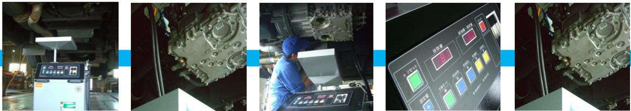
AMC-600をオイルパンの下へセット。レベルゲージ部から、廃油を自動回収。同時に、エレメント部からの廃油は上部オイル受けが回収。
