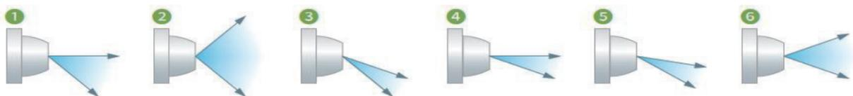
さらに! オートフラップは冷房・暖房運転時に、吹出角度を手元のリモコンで設定可能!
