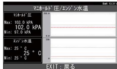
「データモニタ」を選択した際に「リスト表示」と「グラフ表示」の選択画面が表示されます。「グラフ表示」を選択すると2項目までグラフ表示することができます。
