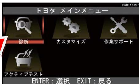
7. システム選択画面が表示されます。目的に合った項目を選択して[ENTER]ボタンを押します。(例：全自己診断の場合)
