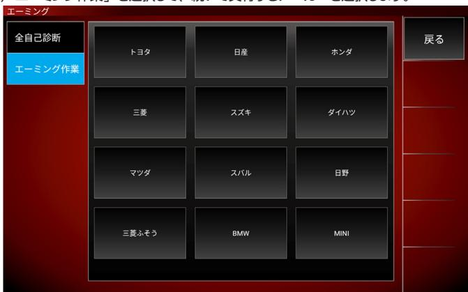
(3) 「5-3-1 診断からの診断ソフトのメインメニュー表示」を参考に実行する車種を選択します。(例：2019年式 三菱EKワゴン) 選択した車種のエーミング項目が表示されます。「フロントカメラ」-「カメラエーミング」を選択します。
