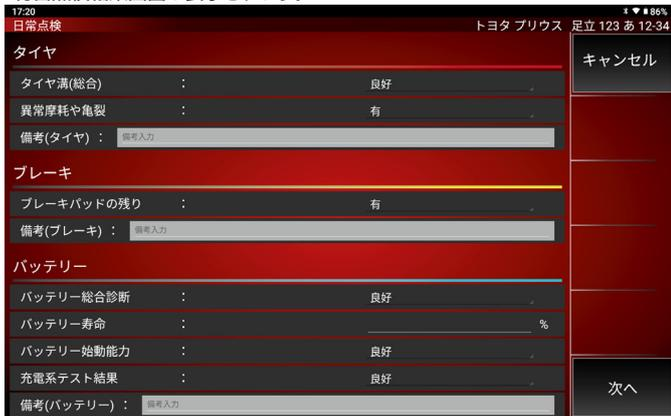
(3) 総合点検結果画面では、診断車両情報、6 システム (エンジン・HV/PHV/EV・トランスミッション・ABS・パワーステアリング・エアバッグ) の自己診断情報、日常点検で入力した点検内容の表示と印刷・保存が行えます。
