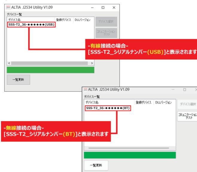
**6. 接続した本体のシリアル番号とデバイス一覧に表示されたシリアル番号が一致していることを確認して、デバイス名をクリックして選択し [ デバイス選択 ] をクリックします。**
