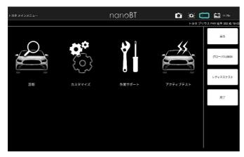
(2) アクティブテストシステム一覧が表示されます。 アクティブテストを実行するシステムを選択します。
