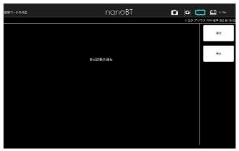
(3) 「実行」を選択すると「自己診断の消去中」のメッセージが表示された後 消去完了画面が表示されます。
