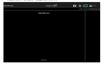
・画面左上の診断結果は、全てのシステムの故障コードが消去された場合には「全システム異常なし」、されていない場合は「○システム異常あり!」が表示されます。
