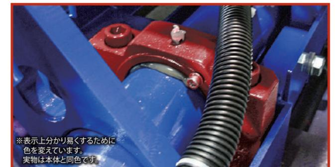
3tEPリフトではリンク部の剛性をアップ。スライドボードと併せて安全に大型乗用車のリフトアップが行えます。
