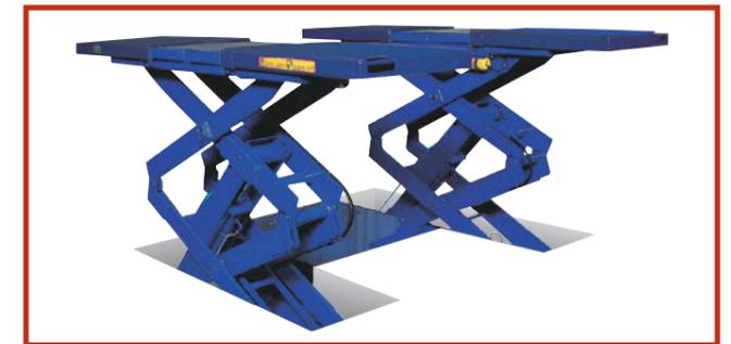
前後方向に最大で550mm\* (片側275mm) ボードがスライドするので、大型乗用車のリフトアップの際にバランスを取り易く安心です。
