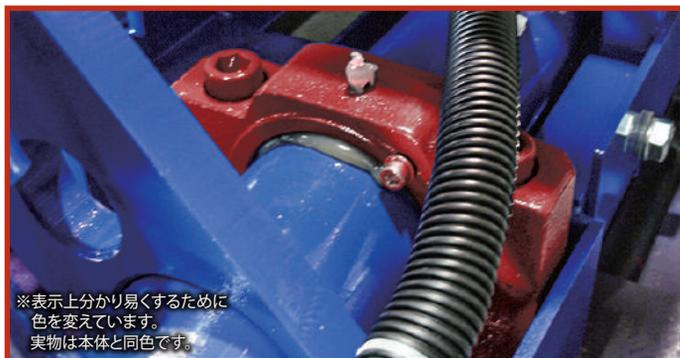
3tEPリフトではリンク部の剛性をアップ。スライドボードと併せて安全に大型乗用車のリフトアップが行えます。
