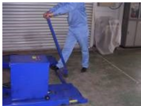
引き起こし終了、リフト接地
