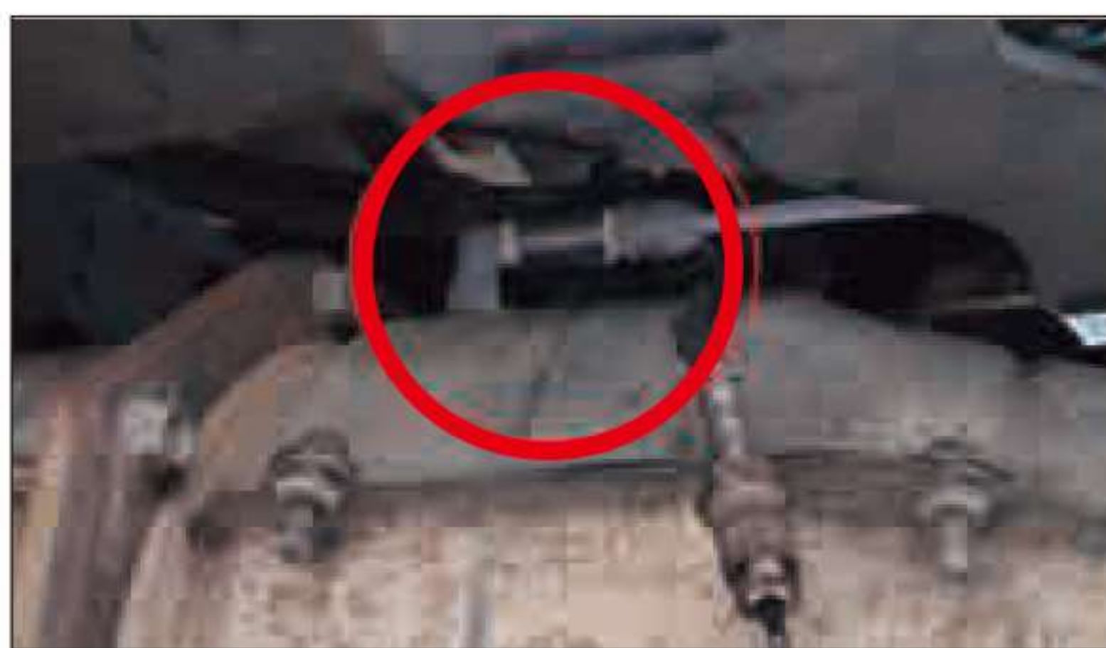
センサーが取付いていた穴にノズルをセットする
