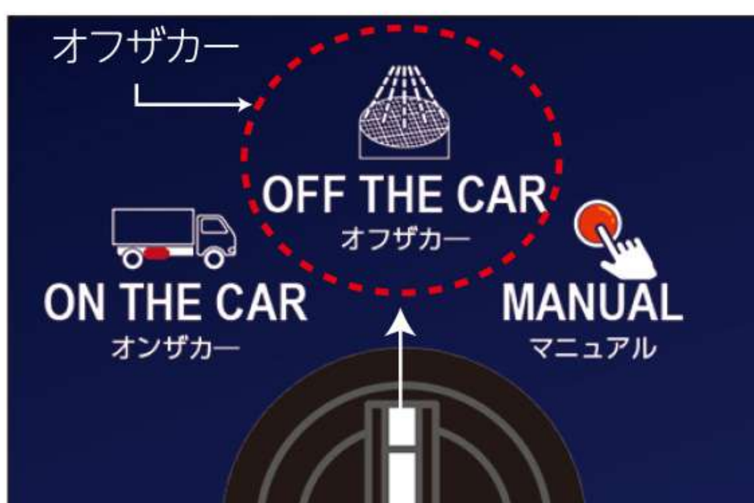
セレクターでオフザカーを選択、洗浄力を設定、運転ボタンを押して自動洗浄スタート
