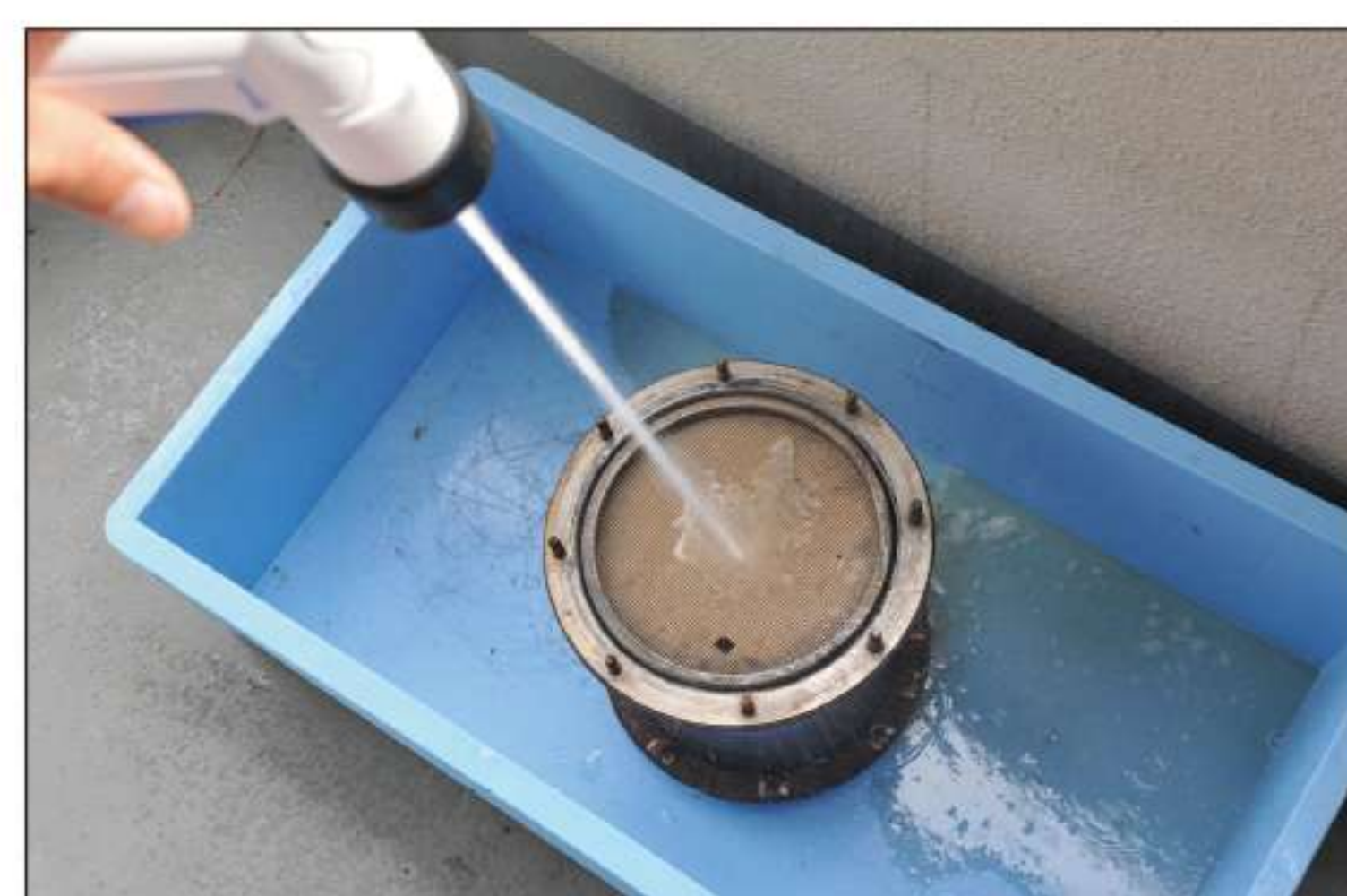
オフザカーアタッチメントを外して、散水ノズルですすぎます
