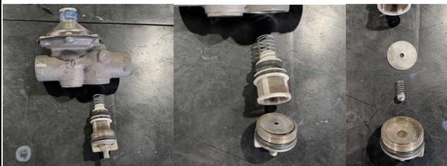
給水ストレーナーの清掃時キャップを取り外すと左写真の様に負圧作動弁用の精密部品が入りますので内部部品がバラバラにならないように取扱いに注意してください。
