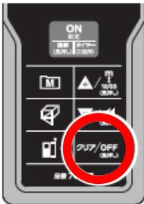
2. クリア・OFFボタンを長押しすると電源が切れます。※メモリーの内容と測定単位の設定はクリア・OFFボタン長押しで電源を切った時点で保存されます。(電池を抜いても保存されます)
