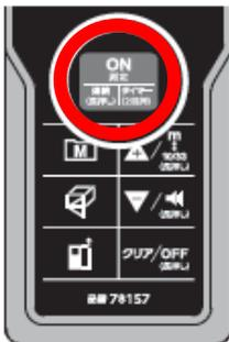
1. 「スタート画面」でON・測定ボタンを押し、レーザーポイントを照射します。
