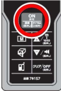
1. 電源がOFFの状態ですべてのボタンを押すと、ディスプレイに下図のような表示が、表示されます。以下この状態を「スタート画面1と呼びます。
