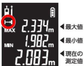
1. 「スタート画面」でON・測定ボタンを長押し(約2秒)すると、連続距離測定表示が点灯し、連続距離測定が開始されます。
