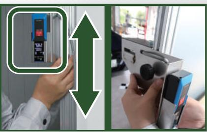
**STEP 5** パネルのレーザーブラケットにレーザー距離計を取付ける。ターゲット設置高さ基準に合わせて、レーザーブラケットの位置を固定する。
