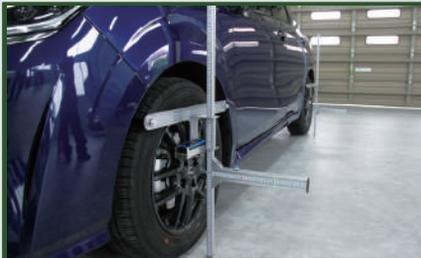
**STEP 2** タイヤアタッチメントを各タイヤに取付け、水平・垂直を確認する。角度調整ハンドルでタイヤアタッチメントの水平目盛に当たるレーザーが前後で同一になるように調整する。
