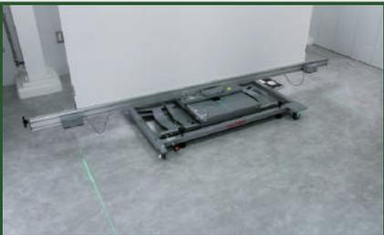
**STEP 1** 作業スペースにスタンドをセットし、レベルを調整する。おおよそ、スタンドから既定の距離に車輛を進入させ、左右のラインレーザーが車輛の外側にあることを確認する。
