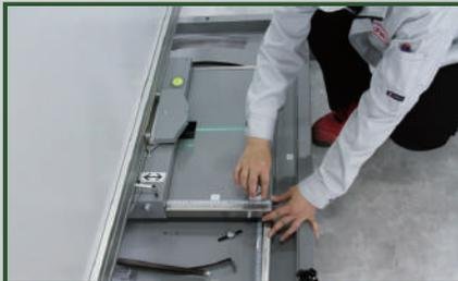
**STEP 3** 左右固定ボルトを緩め、左右のタイヤアタッチメントの水平目盛が同一になるよう調整し、ロックする。
