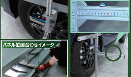
**STEP 4** 左前タイヤアタッチメントにレーザー距離計を取付ける。前後固定ボルトを緩め、車両とパネルの位置を整備要領書記載の基準値に合わせる。
