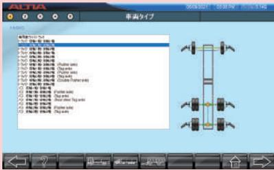
**STEP 2** ホイールクランプを取付け、システム指示に従い、車両の操作をする。
